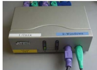
図 3.2 CPU 切替器
